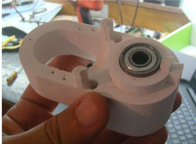
Figura 28 - Garantindo que os rolamentos de suporte entrem justos no nicho cilíndrico do suporte usando uma lixa. NÃO LIXE DEMAIS.
