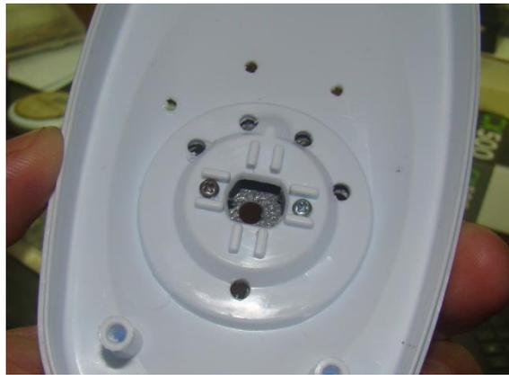
Figura 10 – Furos feitos para a passagem dos botões. Painel parafusado e furos de 3mm de diâmetro para a colocação dos leds de sinalização feitos.
