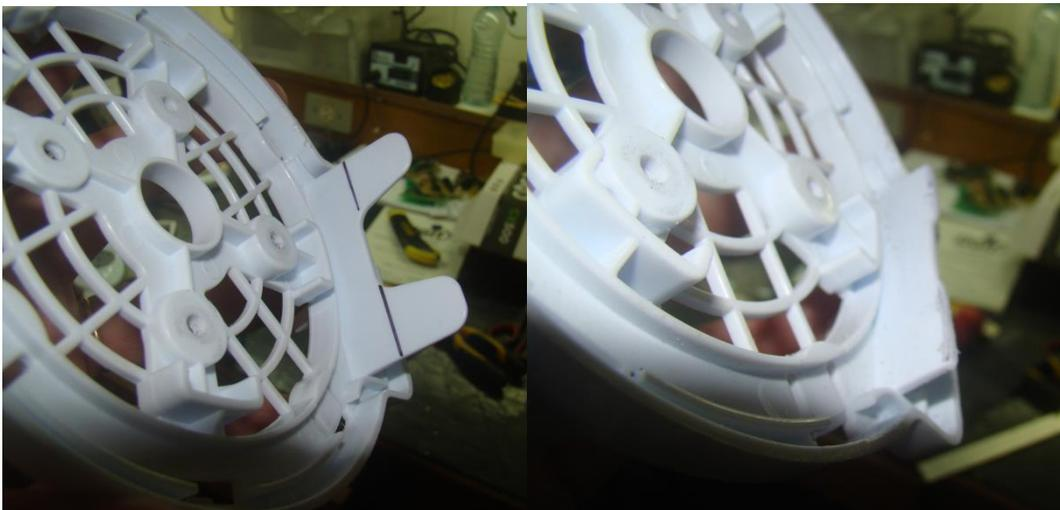
Figura 11 – Marcação e remoção das abas plásticas da parede plástica de suporte da cesta.
