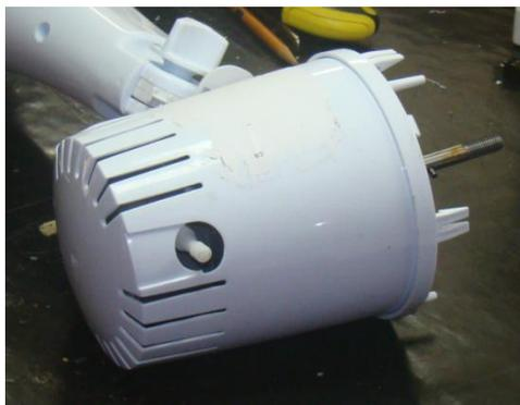
Figura 1 – Remoção do *knob* de basculamento lateral.
