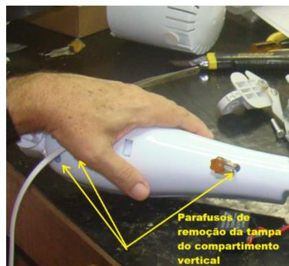
Figura 5 – Remoção dos parafusos de fechamento do compartimento vertical.
