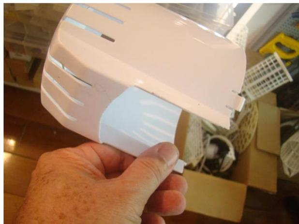
Figura 36 – O resultado do corte da cuia do motor com base na marcação feita com o uso do gabarito da Figura 35.
