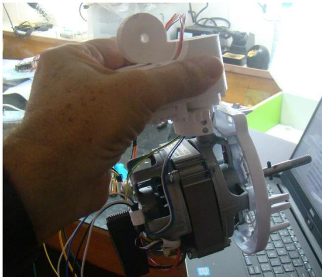
Figura 32 – Teste de travamento do conjunto do motor na base.
