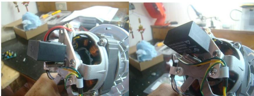
Figura 24 – Arranjo dos fios na saída do motor e posicionamento do capacitor.
