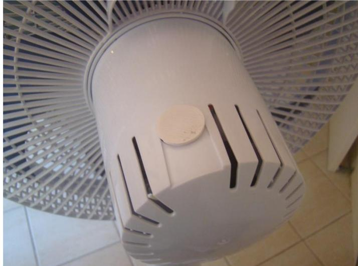
Figura 37 - Tampinha do furo deixado pela retirada do *knob* de oscilação lateral.
