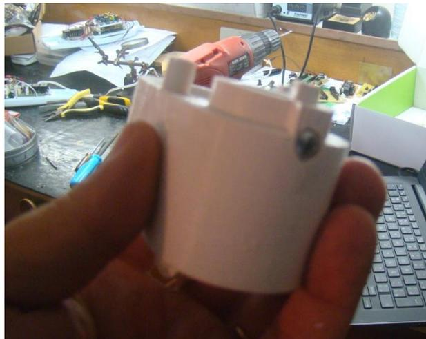
Figura 27 – Posicionamento no suporte do parafuso de travamento do motor.
