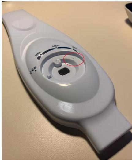
Figura 7 – Remoção do batente da direita da tampa do compartimento vertical.
