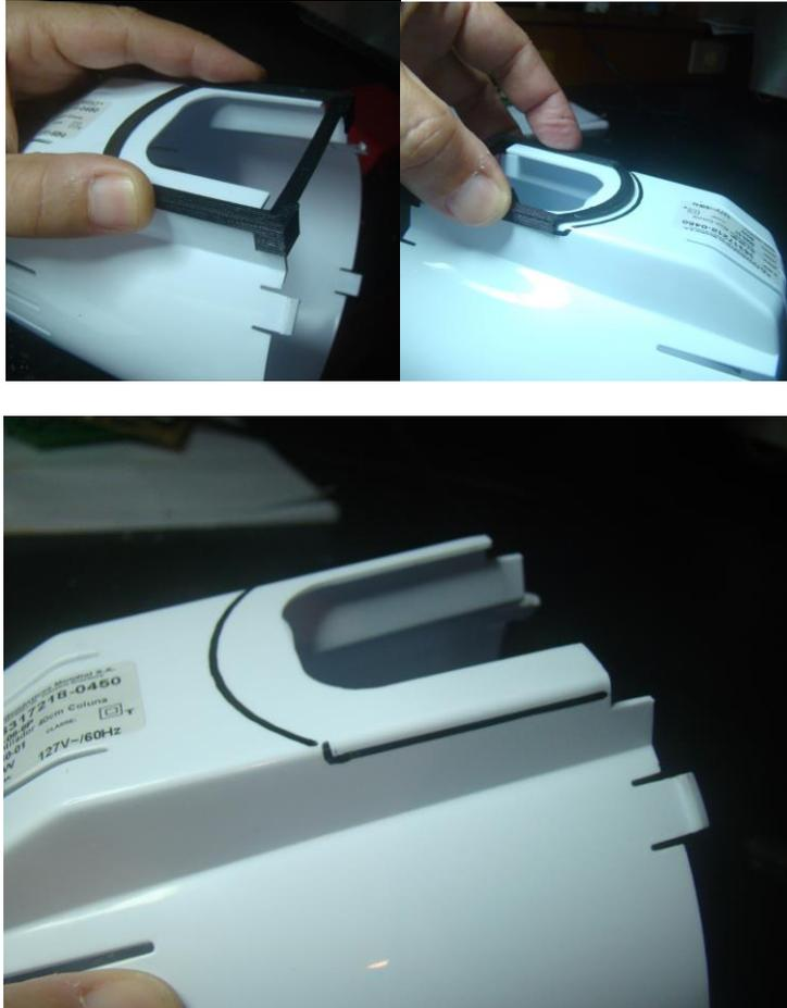
Figura 35 – Marcação da cuia do motor com o uso do gabarito. Notar que a marcação é feita com a caneta de marcação contornando externamente o gabarito.
