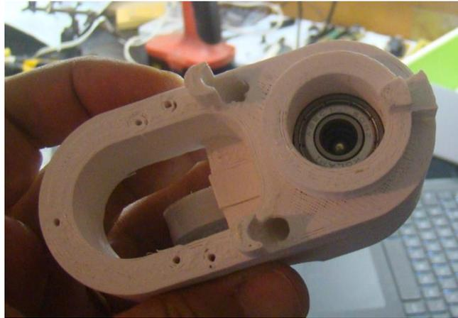
Figura 29 – Esfera de apoio do eixo de basculamento colocada no fundo do copo e primeiro rolamento introduzindo até o fundo no nicho.
